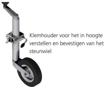
Standaard steunwiel (verstelling via klemhouders en schroefvijzel)
