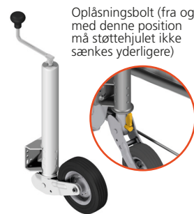
Automatisk støttehjul (grovjustering via klappmekanisme og spindeldrev)
